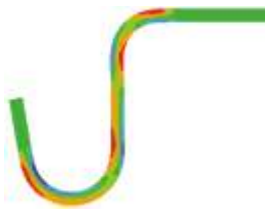
Biegung eines Kontaktelements mit Rückfederung. Die berechnete Rückfederung und damit die Endgeometrie hängt vom richtigen Verfestigungsgesetz ab (Simulation)
