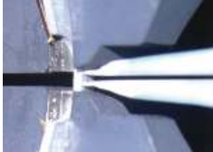
Zug-Druckversuche an kleinen CuMg Stäbchen. Parameterermittlung, um in der Simulation die Rückfederung zu beherrschen
